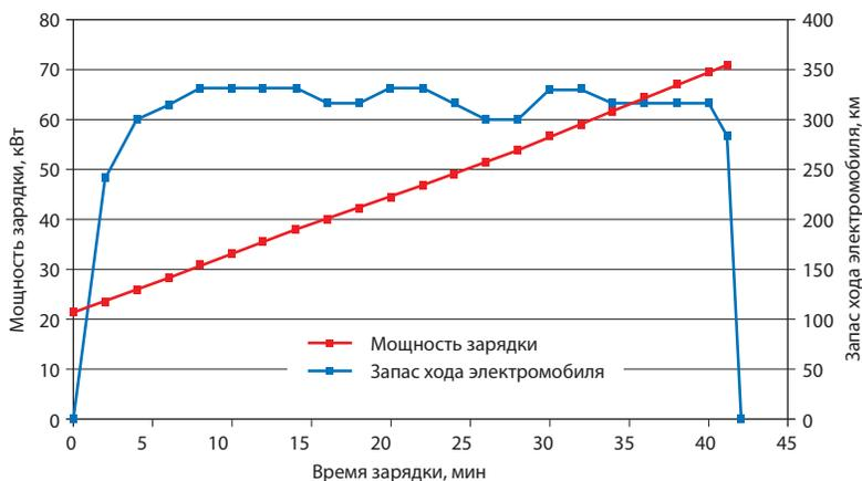
**Рис. 4.** График быстрой зарядки ВВБ электромобиля, выполненной 13 ноября 2023 года
