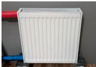
■ Рис. 4. Панельный радиатор тип 22 в испытательной камере
