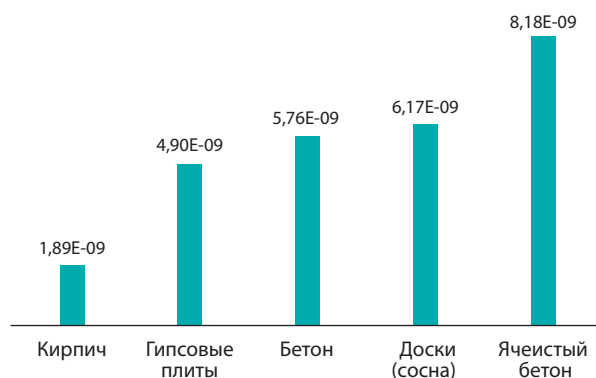
Рис. 3. Влагопоглощение поверхности ограждающих конструкций из различных материалов, кг/(м 2 •с•Па), при суточных колебаниях влажности
