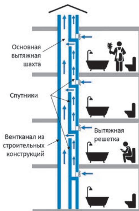
Рис. 6. Схема 2. Шахты и спутники в строительном исполнении. Применяется не только в типовых жилых домах, как принято думать. Современные заводские инженерные блоки активно применяются и в элитном жилье
