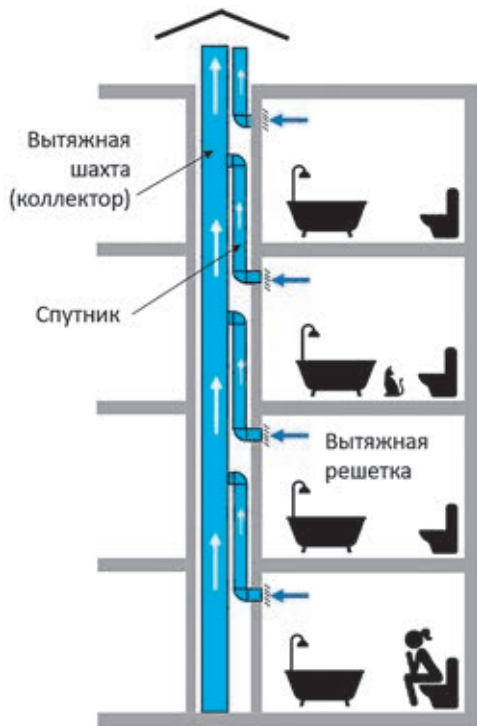
■ Рис. 7. Схема 3. Шахты и спутники, выполненные из стальных воздуховодов. Традиционная схема
