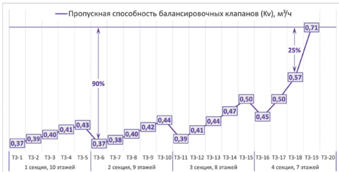
изменений. В диктующем кольце потери напора максимальные – 6 м. Так как разбалансировка потерь напора больше 10 %, необходимо применить балансировочные клапаны. Разбалансировка потерь напора описана в нормативно-технической литературе, но это лишь один из четырех параметров, которые нужно учитывать при расчете режима циркуляции.
