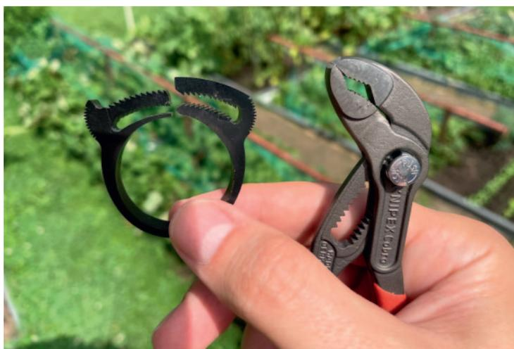
Зажимать можно руками или же (если требуется более надежная фиксация) небольшим ключом. Снимается такой хомут опять же с помощью ключа или пассатижей – зажимаем один край и чуть поворачиваем его.
