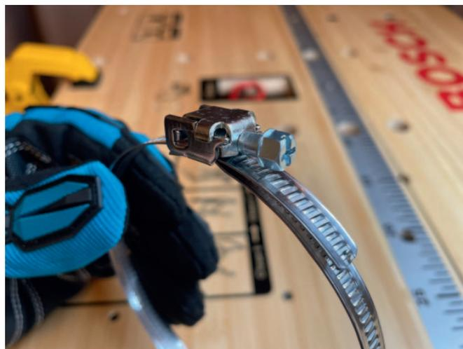
Снимается хомут тоже просто – надо отверткой ослабить винт, откинуть замок и вытащить
