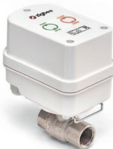
**Winner ZigBee – новый привод от Gidrolock для обнаружения протечек и предотвращения потопов, передает сигналы аварии через ZigBee, управляется через приложение Smart Life и работает до двух лет на встроенных батареях с возможностью резервного питания**
