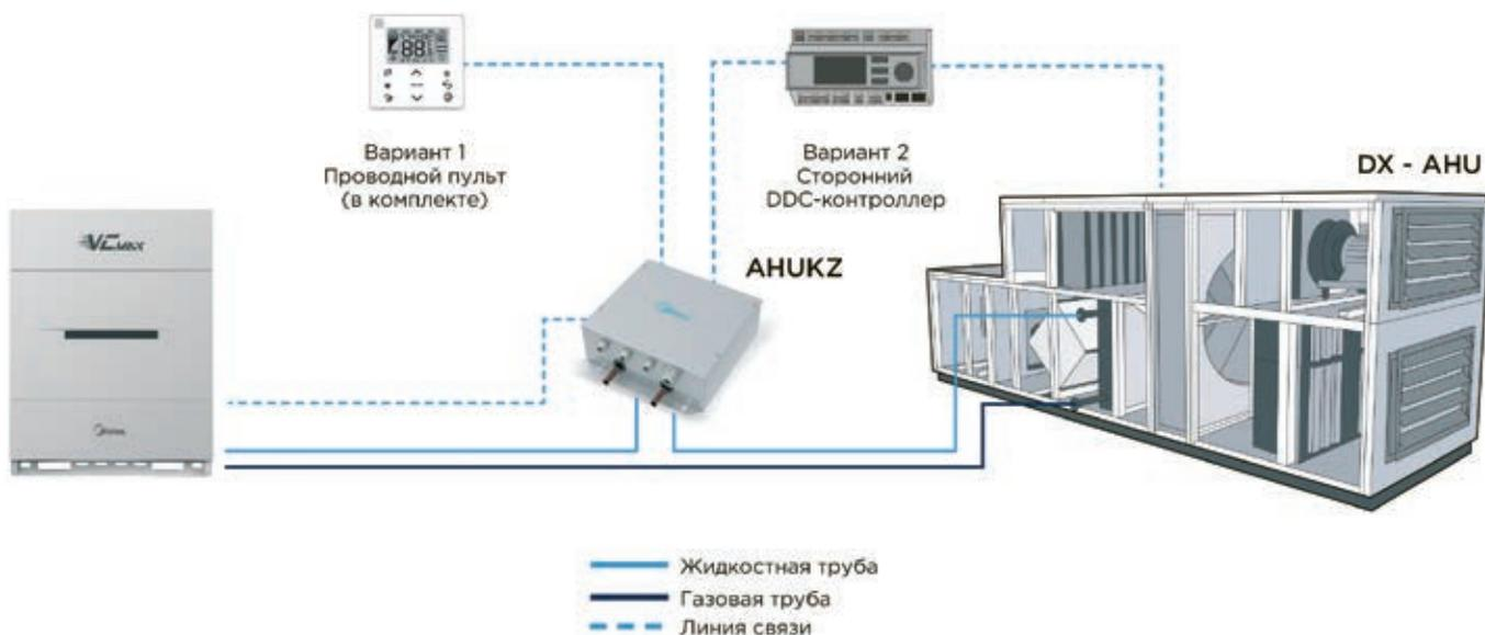
Объединение АНУ-КИТ для достижения суммарной производительности позволяет собрать систему для подключения к испарителю холодопроизводительностью до 340 кВт.
