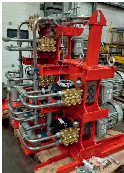
Рис. 9. Насосная установка ТРВ ВД
