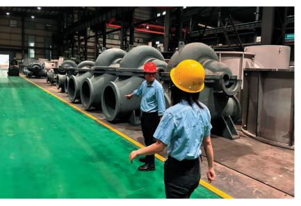
производить компоненты из других материалов: корпус насоса – чугун с шаровидным графитом QT400-18 или литая сталь ZG230-450; рабочее колесо – нержавеющая сталь AISI304/AISI316 или дуплексная сталь DSS2205.
