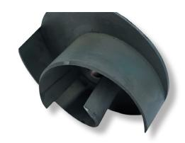
графитом QT500-7. Все рабочие колеса разрабатываются с использованием расчетов CFD (Computational Fluid Dynamics), что обеспечивает высокую эффективность и надежность. На финальном этапе изготовления рабочего колеса каждая единица проходит динамическую балансировку, что гарантирует долговечность и качество каждого насосного агрегата.
