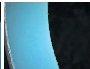
№ 4. PE-RT II. Внутренний слой после испытаний в хлоре
